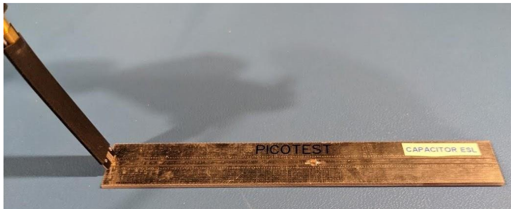
Fig. 18 - 使用P2104A探头测量串联电容的ESL的TDR测量装置.
