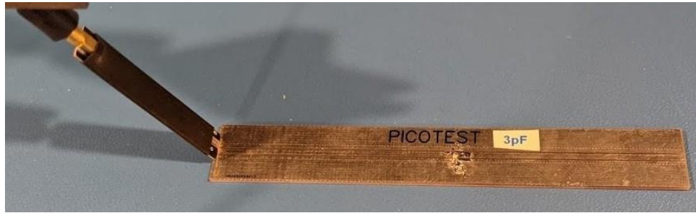
Fig. 13 - 使用P2104A探头对3pF电容的TDR测量设置。
