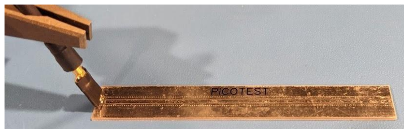
Fig. 9 - P2105A探头和50Ω微带传输线的TDR设置.
