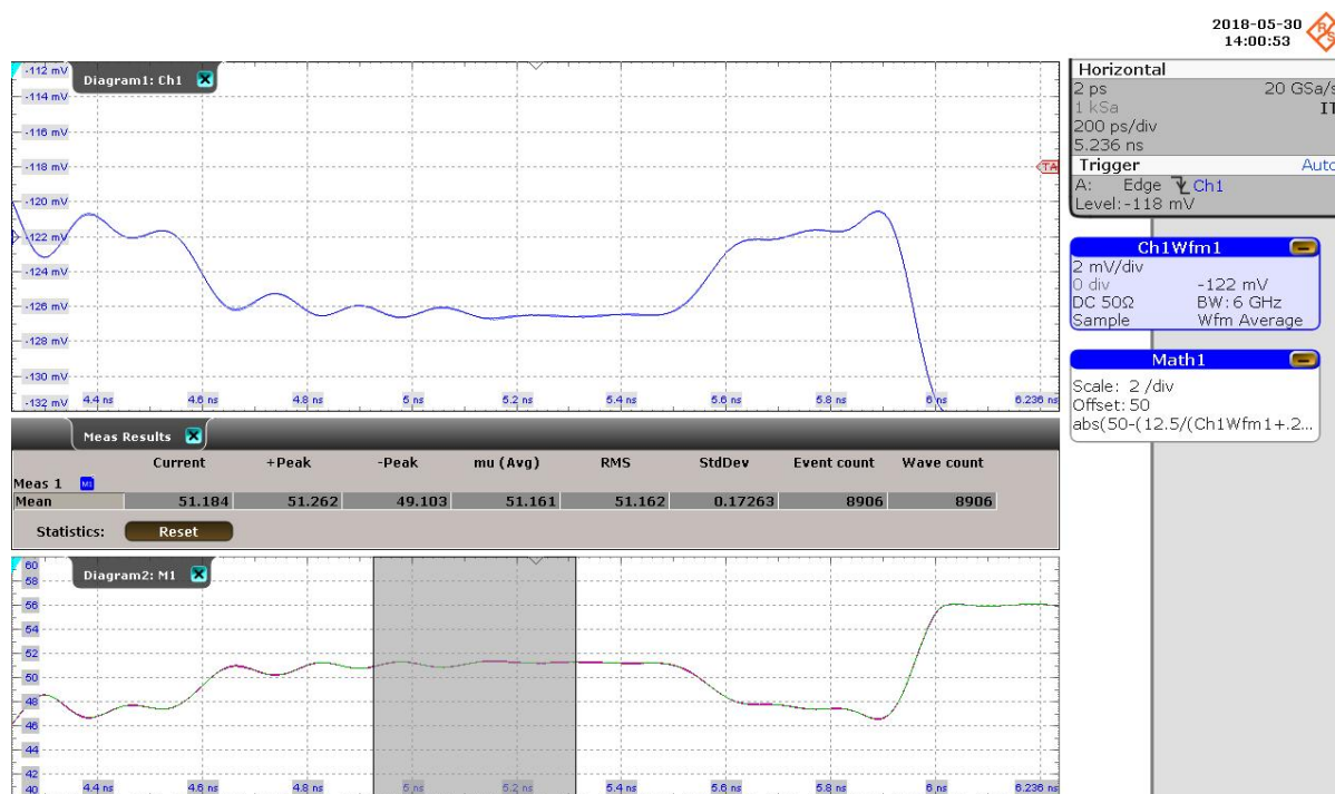
图3: 从图3中所示的Picotest TDR演示板测量导线Trace4, 显示了阻抗从47欧姆到52欧姆的阶梯变化。使用公式(9)绘制阻抗图。
