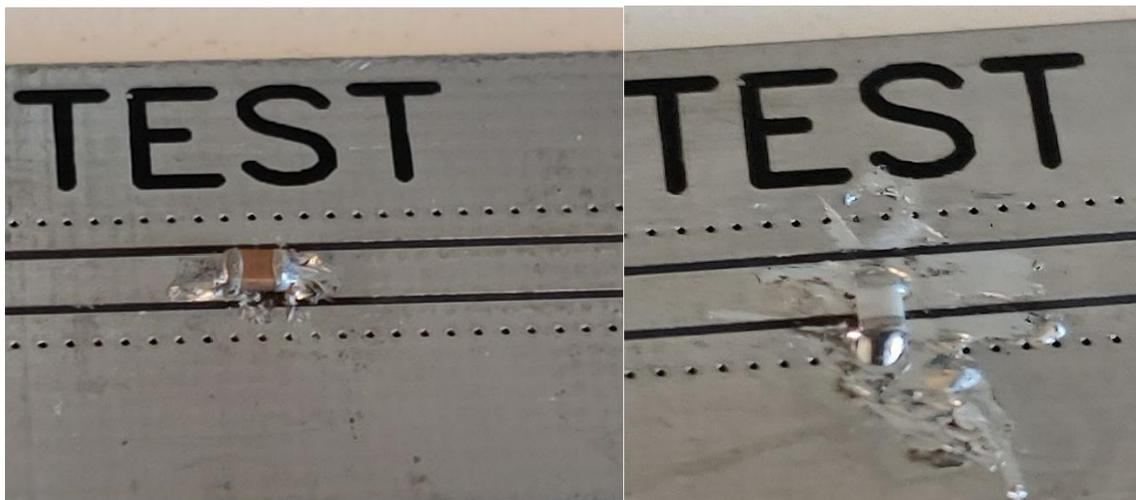
图4：已安装的电容器的特写视图。在左侧演示板上切割中心导线，串联电容器焊接。一个500fF电容器被焊接在右侧演示板上的中心导线和接地之间。
