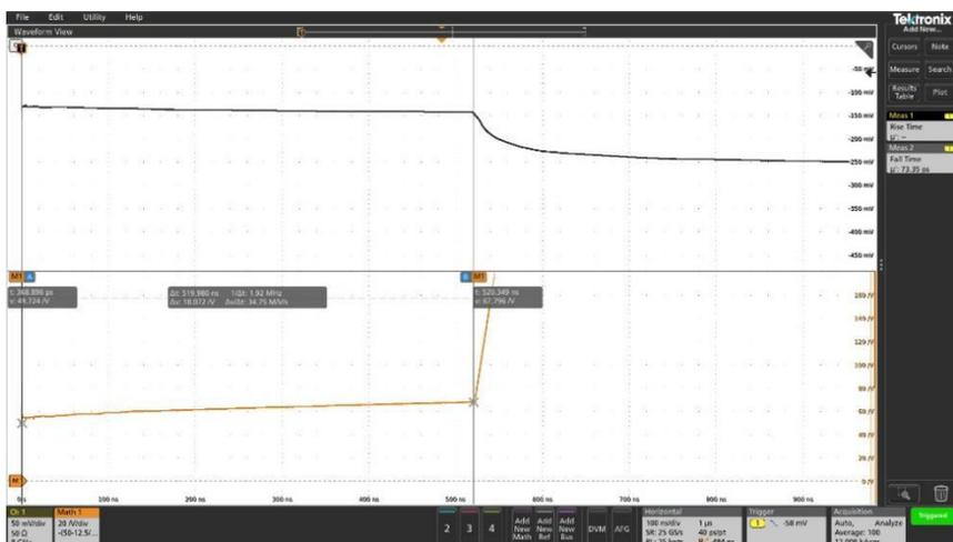
从 50m 线缆的反射测量中捕获的 TDR 响应。线缆是一个低通滤波器，线缆衰减 TDR 信号中的高频成分。由于线缆的损耗，上升时间和下降时间也逐渐下降。
