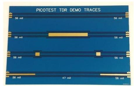
J2151A附带的TDR测试样板，包含50 Ω印刷线路，“Beatty standard”印刷线路，间隔3英寸的50欧姆印刷线路，以及测试介电常数和阻抗波动 (50 Ω to ~52.5 Ω)的线路。
