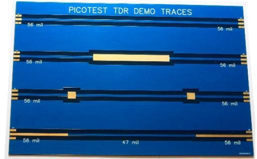
TDR PCB标准测试演示板（J2151A 包含）包括4组具有精密制造的导线。
