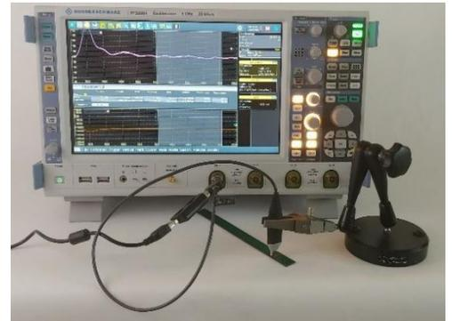
使用PerfectPulse®发生器和单端口PDN探头进行样线导线测试。
